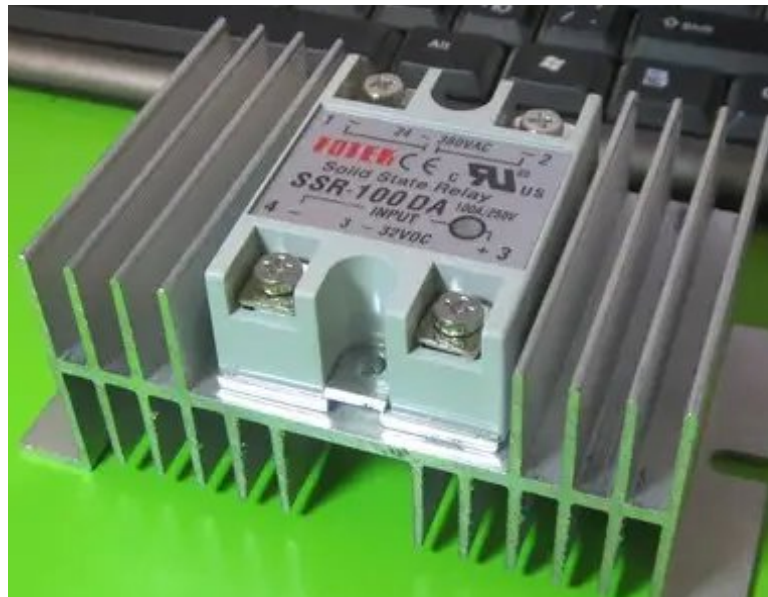
Рисунок 2.9 - Реле SSR-100DA встановлене на радіатор
