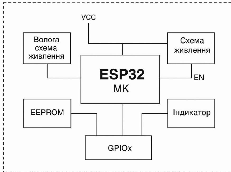
Рисунок 3.2 – Блок-схема мікроконтролера ESP32 у складі пристрою
