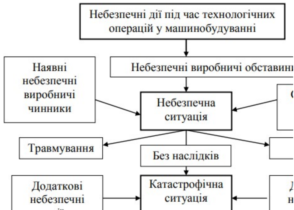
Рисунок 4.1 – Аналітична блок-схема, що відображає процеси формування небезпечних, аварійних та катастрофічних ситуацій у машинобудівній галузі
