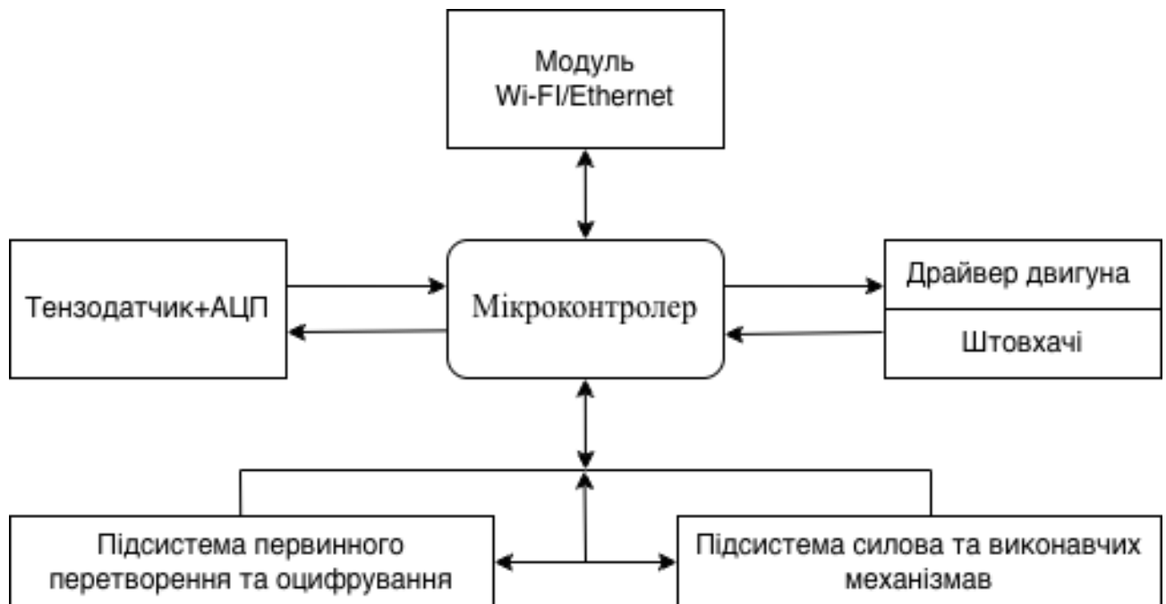
Рисунок 2.1 – Функціонально-структурна схема кіберфізичної системи
