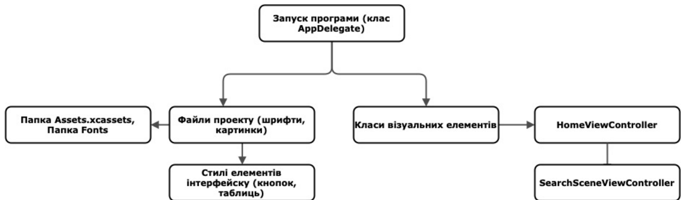
Рисунок 3.5 – Структурна схема програмного забезпечення для прокладання та візуалізації маршрутів у реальному часі
