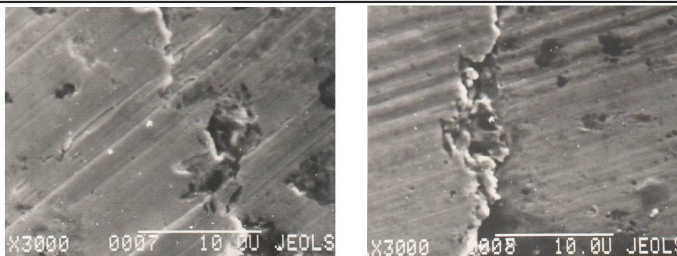
Рис. 7 – Поверхности трения покрытия FeAl 2 -Ti-Si, иллюстрирующие кинетику процесса разрушения, после испытаний при 650 °C
