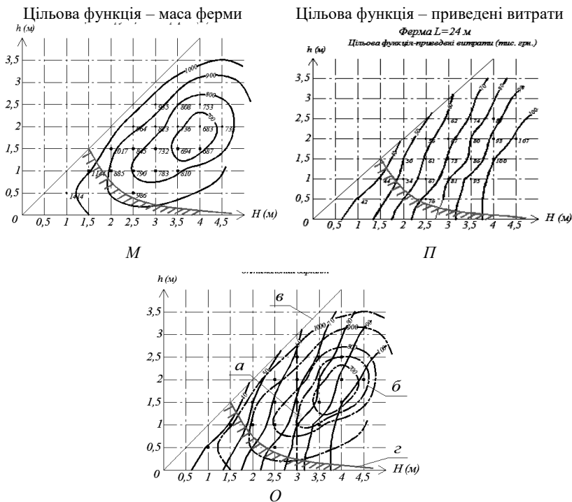
Рис. 2. Результати оптимального проектування ферми прольотом 24 м та лінії рівнів цільових функцій:
