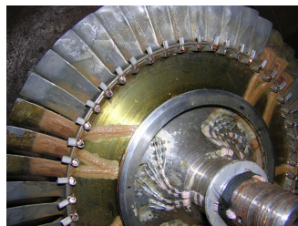
Рис.6. Доработанная конструкция блиска с демпферами
