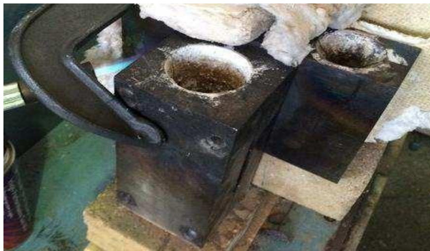
Малюнок 11 – циліндричний сталевий кокиль
