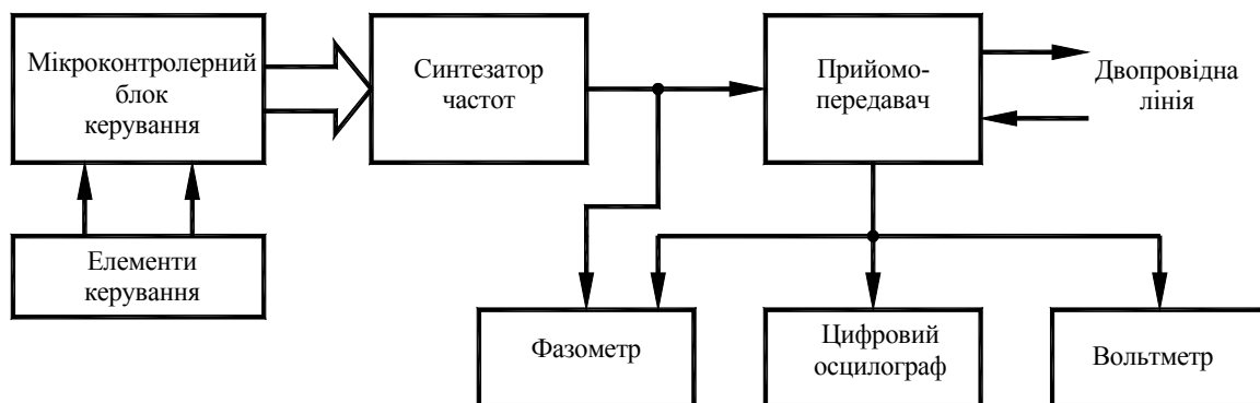
Рис. 3. Блок-схема лабораторного макету дослідження аналітичного багаточастотного фазового методу вимірювання дальностей
