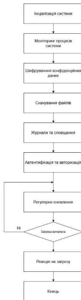
Рисунок 2.5 – Алгоритм виявлення загроз системою моніторингу
