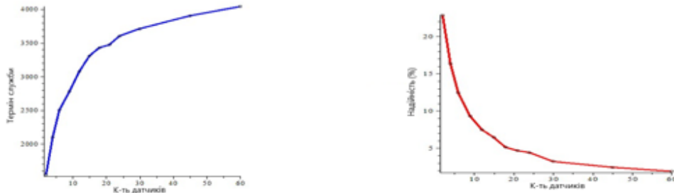
Рисунок 5 – а) Взаємозв'язок кількості датчиків та терміну служби б) Взаємозв'язок кількості датчиків та надійності.
