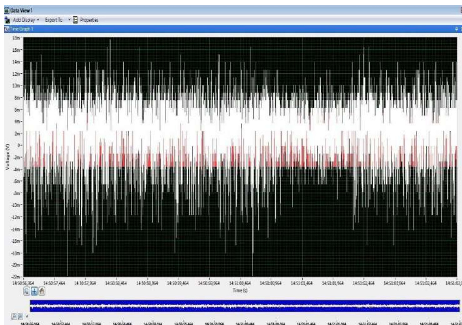
Рисунок 4.1 – Загальний вигляд графіка, залежність віброприскорення від часу проведення експерименту, шарнір №1, величина осьового зазору 0,01 мм. Експеримент №1
