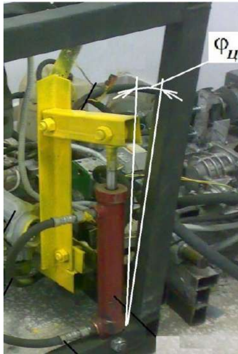
Рисунок 3.7 - Нахил вертикального гідроциліндра в поздовжній площині на кут \varphi_{Ц}
