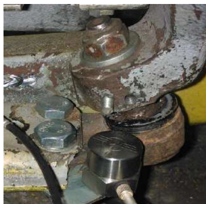
Рисунок 5.1 – Приклад встановлення та орієнтації вібродатчика при діагностуванні кульового шарніра в умовах автосервісних підприємств
