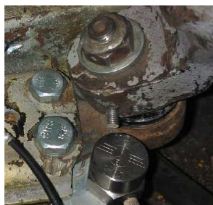
Рисунок 5.1 – Приклад встановлення та орієнтації вібродатчика при діагностуванні кульового шарніра в умовах автосервісних підприємств
