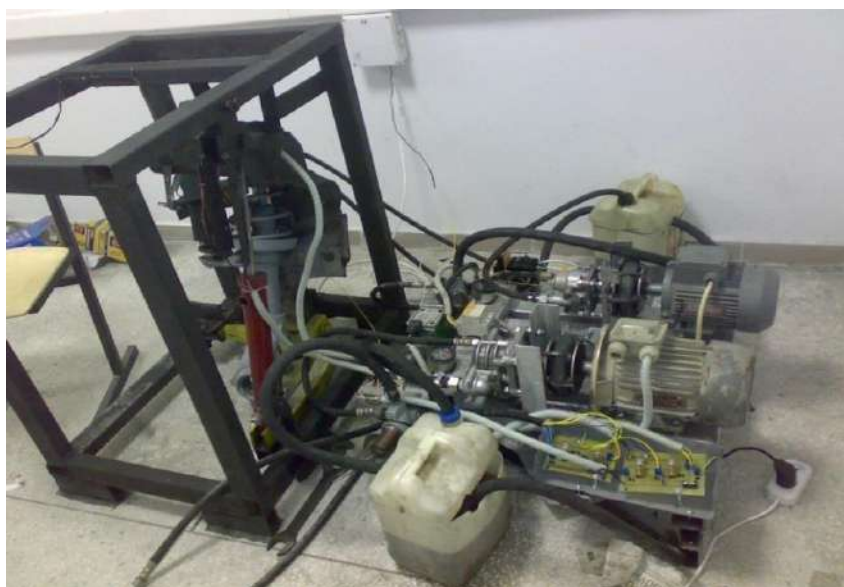
Рисунок 3.4 – Загальний вигляд стенду для випробування та діагностування елементів підвіски. Вид з боку електрогідравлічного приводу
