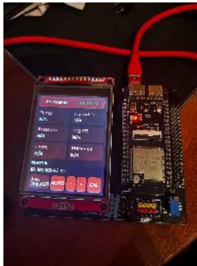
Рисунок 3.2 – TFT-дисплей для відображення параметрів системи очищення повітря
