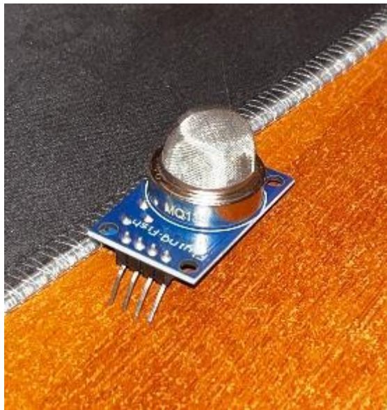
Рисунок 1.12 – Модуль датчика концентрації газів MQ-135
