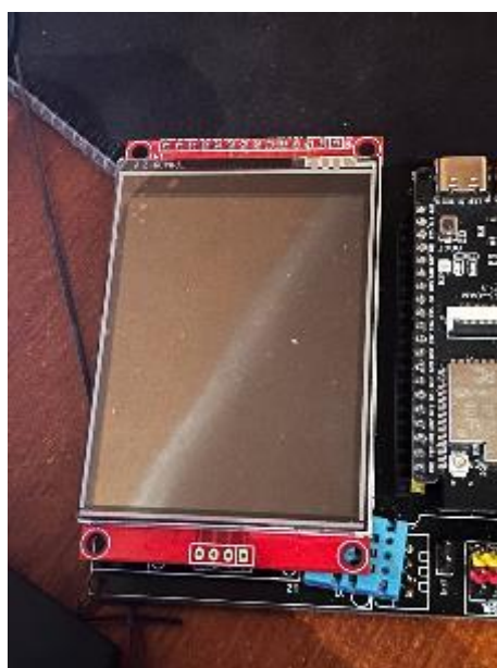
Рисунок 1.11 – Дисплей з тачскріном ILI9341
