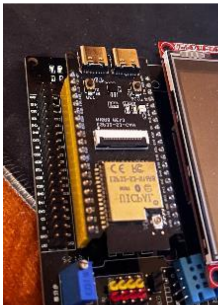
Рисунок 2.1 – Мікроконтролер ESP32-S3 як центральний вузол апаратно-програмного комплексу
