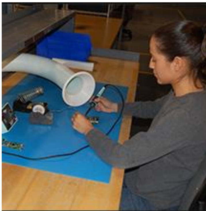
Рисунок 3.1 – Робоче місце з локальним відсмоктуванням випарів під час паяння [22]
