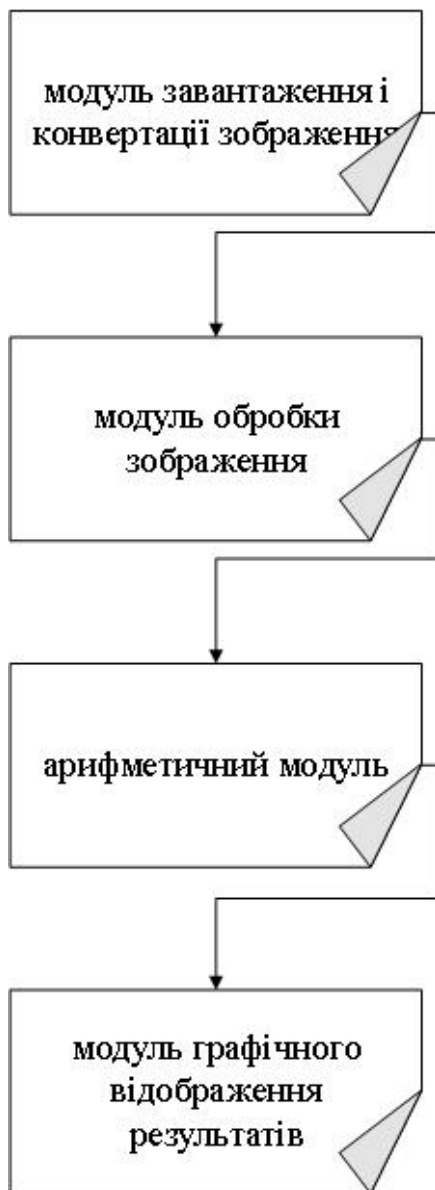
Рисунок 3.4 – Функціональний зв'язок модулів програмної системи методу вимірювання за аналізом зображень
