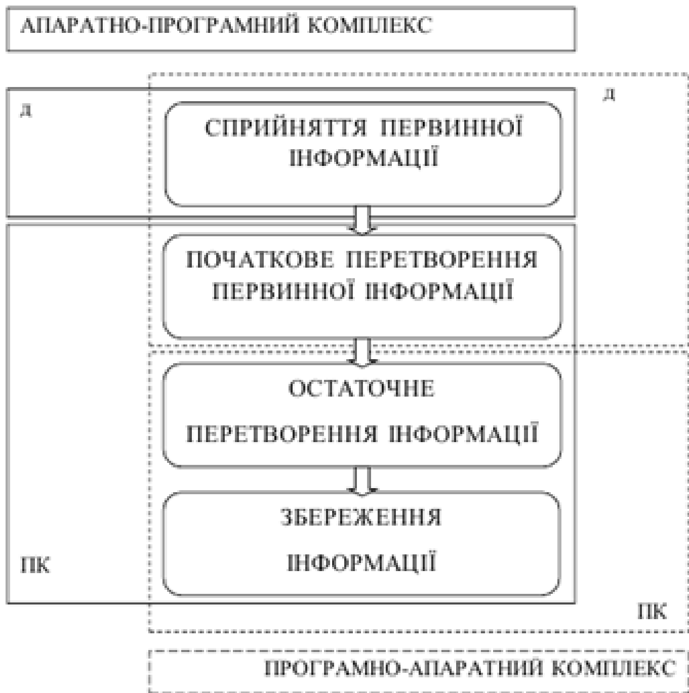
Рисунок 2.5 – Функції апаратно-програмних та програмно-апаратних комплексів
