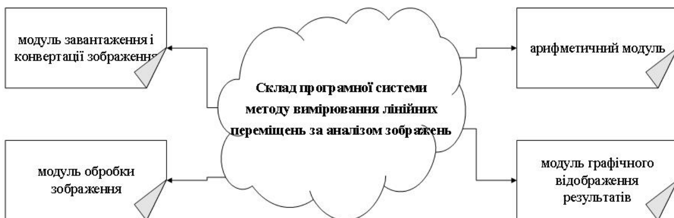
Рисунок 3.3 – Склад програмної системи методу вимірювання лінійних переміщень за аналізом зображень
