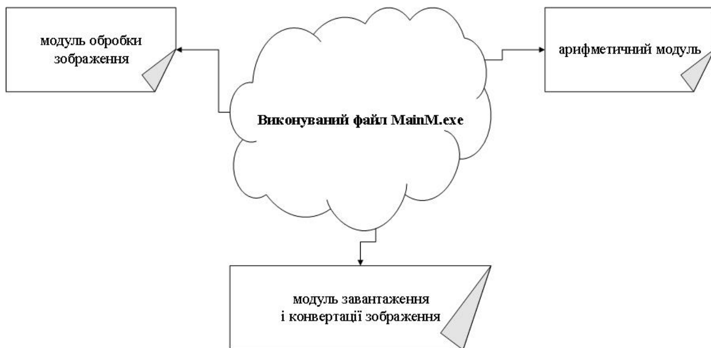
Рисунок 3.6 – Склад виконуваного файлу MainM.exe програмної системи методу вимірювання лінійних переміщень за аналізом зображень
