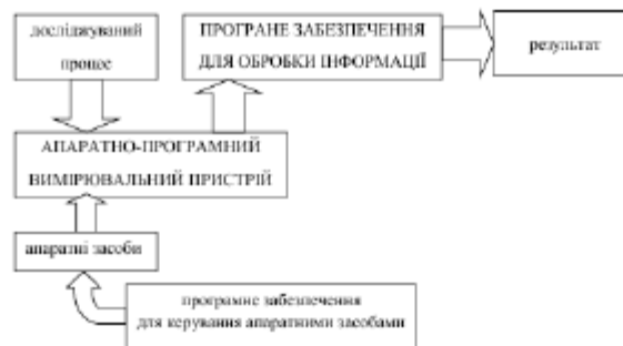
Рис. 2 – Схема застосування інформаційних технологій в трибологічних експериментальних дослідженнях з деталізацією складу програмного забезпечення
