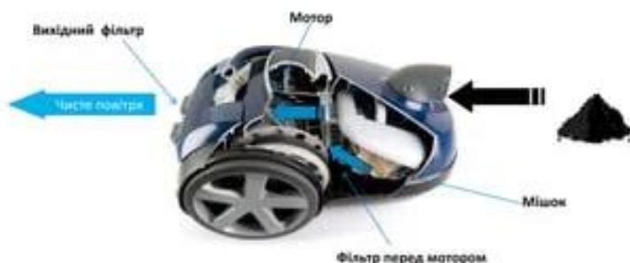
Рисунок 1.2 – Система фільтрації в мішковому пилососі
