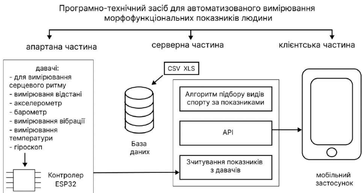
Рисунок 4.1 Схема програмно-технічного засобу для автоматизованого вимірювання морфофункціональних показників людини
