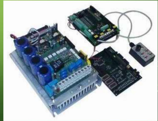
Загальний вигляд плат частотного перетворювача
