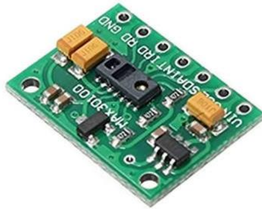
Рисунок 2.1 – Зовнішній вигляд пульсоксиметра МАХ30100
