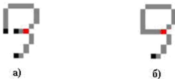
Рисунок 1.9 – Приклад топологічних ознак: а) початкове зображення символу; б) символ із склеєними лініями.
