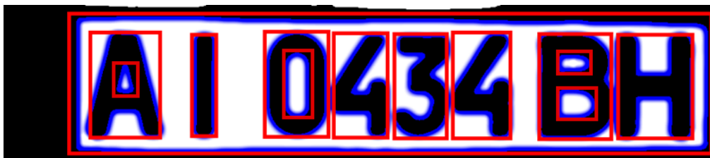
Рисунок 2.9 – Результат виділення замкнутих контурів
