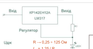
Рис. 1 – Схема найпростішого лінійного стабілізатора струму
