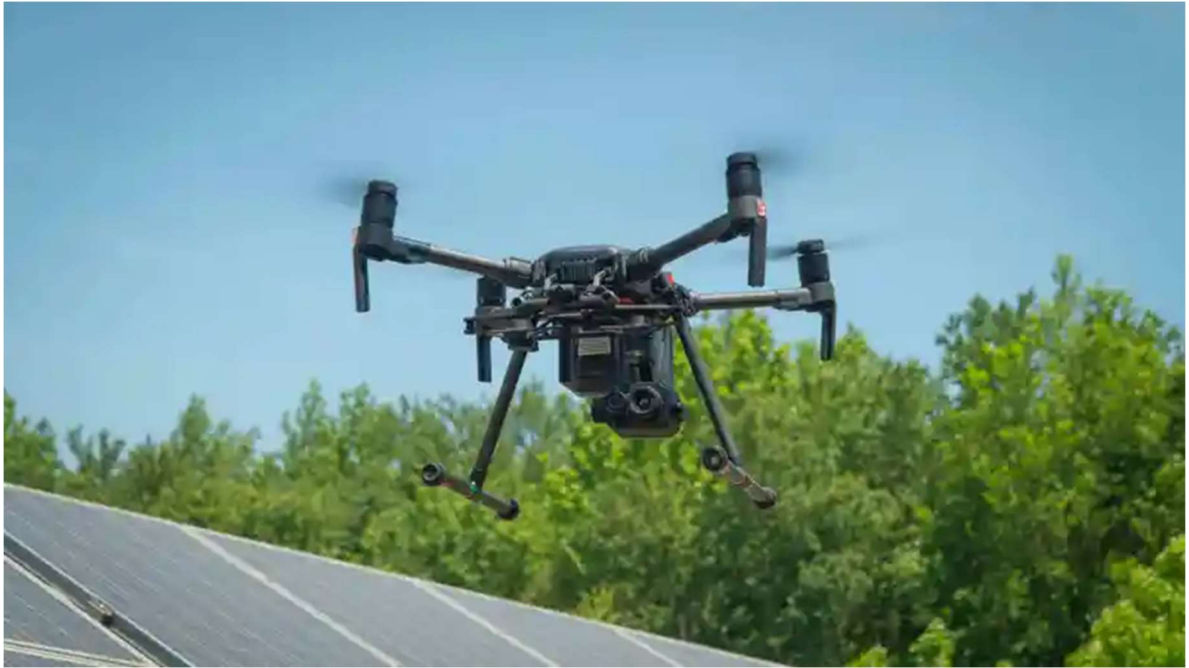
Рисунок 1.1 - Безпілотний літальний апарат з встановленою тепловізійною камерою в процесі обльоту сонячних панелей для їх інспекції [41]
