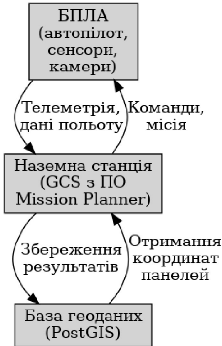
Рисунок 2.2 – Алгоритм роботи кіберфізичної системи для моніторингу сонячних панелей за допомогою БПЛА
