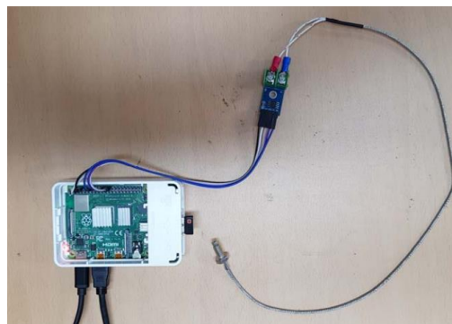
Рисунок 4.3 - Під'єднання одноплатного комп'ютера Raspberry Pi до термопары з драйвером MAX6675
