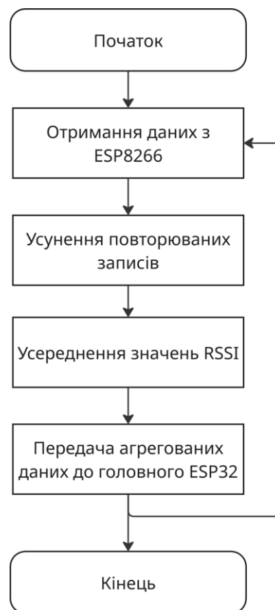
Рисунок 2.5 – Блок-схема роботи ESP32 (Збирач)
