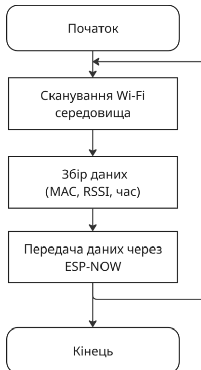
Рисунок 2.4 – Блок-схема роботи ESP8266
