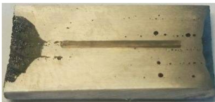
Рис. 20 – Зразок із матеріалу БрО10Ф1 з твердими мастильними компонентами після випробування. На поверхні спостерігається рівномірний гладкий слід зношування
