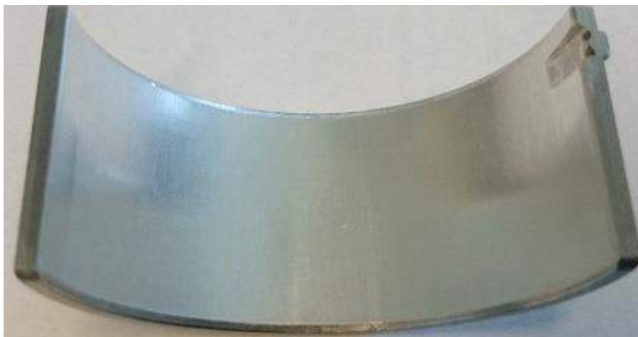
Рис. 16 – Вкладиш підшипника до випробувань на зношування
