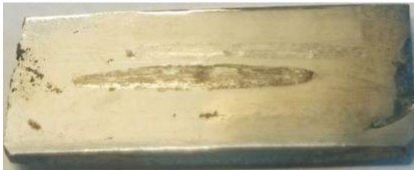
Рис. 23 – Сталь 40Х після випробувань з шорстким слідом зношування
