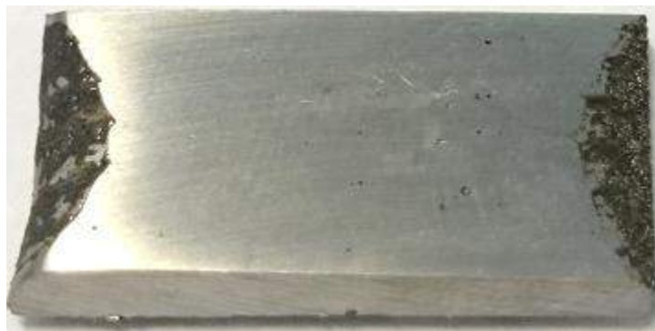
Рис. 19 – Відшліфований вкладиш. На поверхні чітко спостерігаються пори
