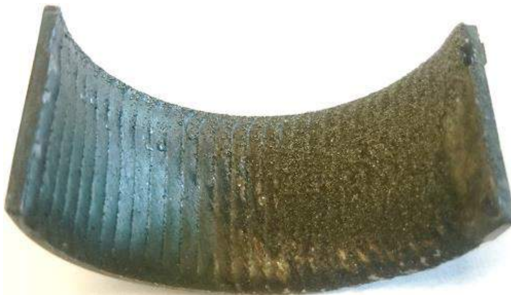
Рис. 18 – Вкладиш підшипника після лазерного наплавлення
