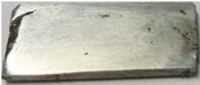
Рис. 22 – Відшліфована Сталь 40Х. На поверхні чітко спостерігаються пори
