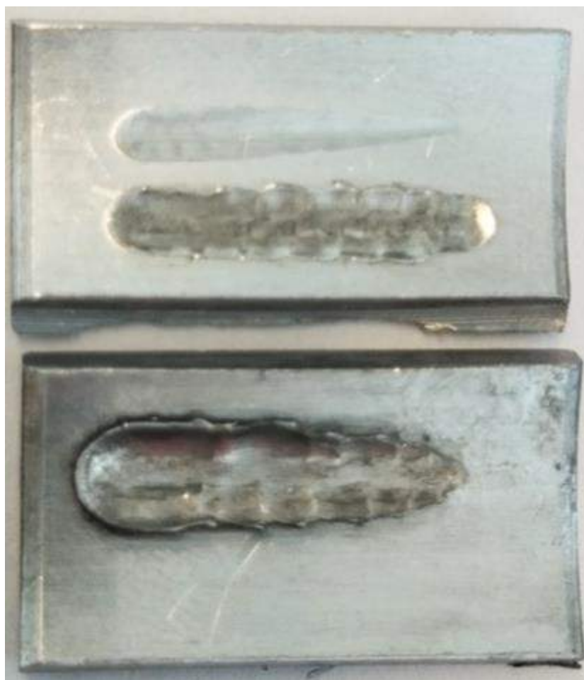
Рис. 15 – Еталонні матеріали після випробувань із бороздами на поверхні
