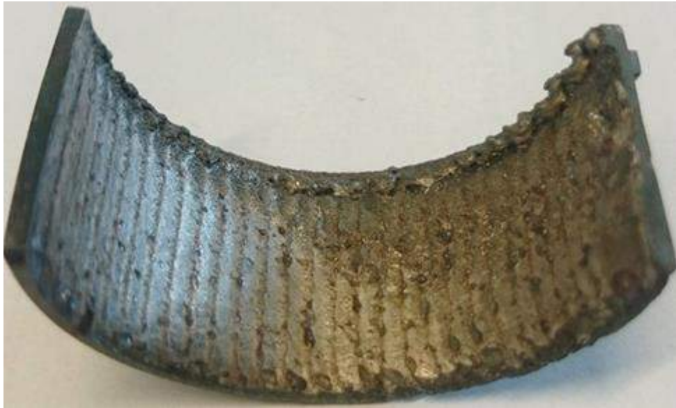
Рис. 21 – Вкладиш підшипника після лазерного наплавлення. Сталь 40Х
