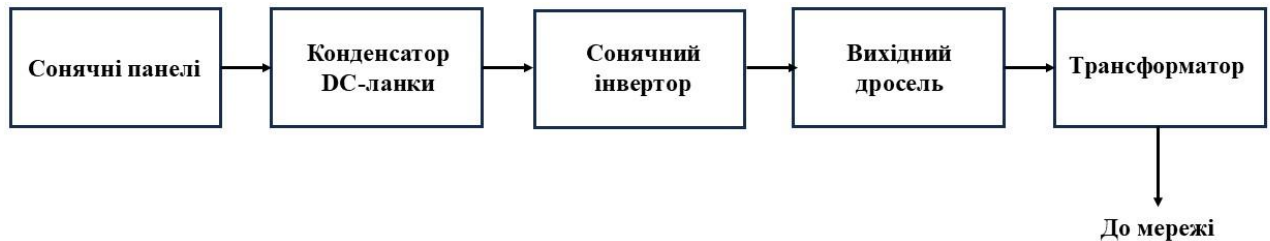
Рисунок 2.1 – Структурна схема сонячної електростанції
