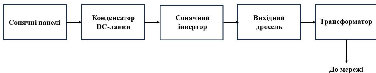
Рис. 1. Структурна схема сонячної електростанції
