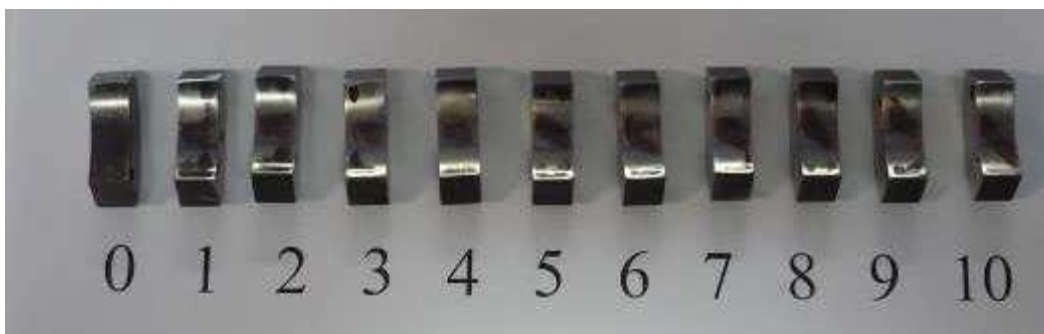
Рисунок 3.16 – Зразки колодок із вставками з міді
