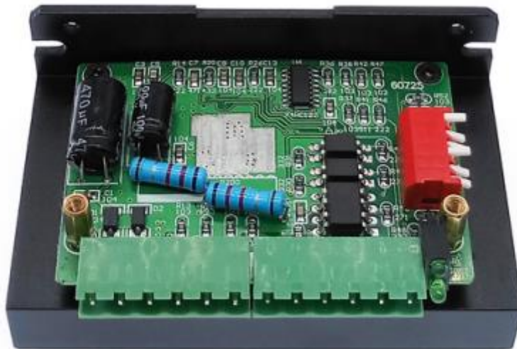
Рисунок 1.11 – Вигляд драйвера ТВ6600 без корпусу
