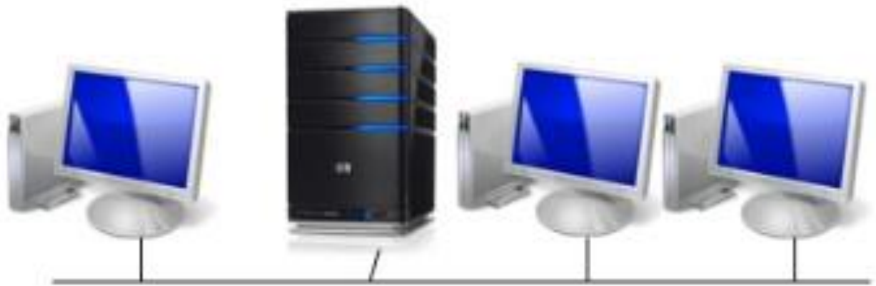
Рисунок 1.1 – Мережева топологія шина
