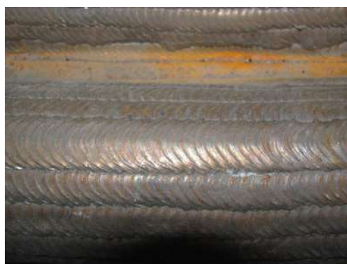
Рисунок 1.10 - Макроструктура наплавленого шару
