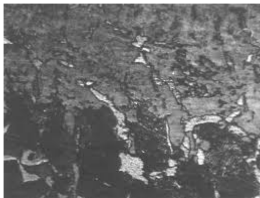
Рисунок 4.4 - Структура сталі після лазерного гартування
