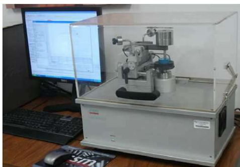
Рисунок 3.18. Схема автоматизованої машини тертя (Tribometer, CSM Instruments )
