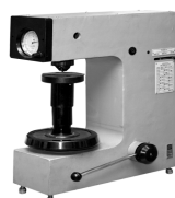
Рисунок 3.16 – Зовнішній вигляд приладу для вимірювання твердості за методом Роквелла (ТР 5006)
