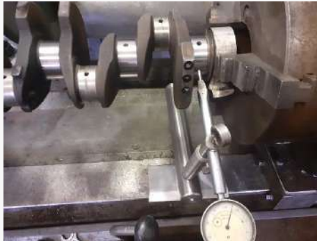
Рисунок 3.7 - Визначення конусності шийок після експлуатації
