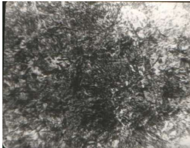
Рисунок 4.2 - Мікроструктура сталі 40X після гартування - мартенсит
