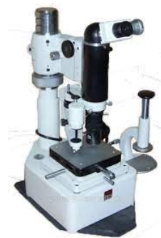
Рисунок 3.17 – Зовнішній вигляд твердоміра марки ПМТ-3
