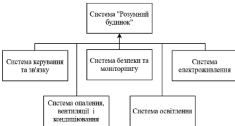
Рисунок 1.1 Види підсистем технології "Smart house"
