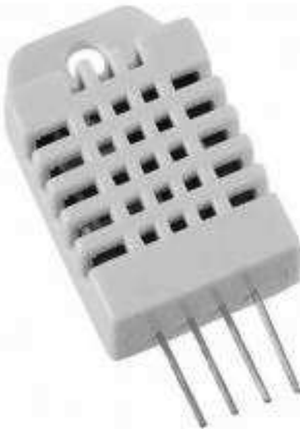
Рисунок 3.6 Зображення датчика вологи та температури
