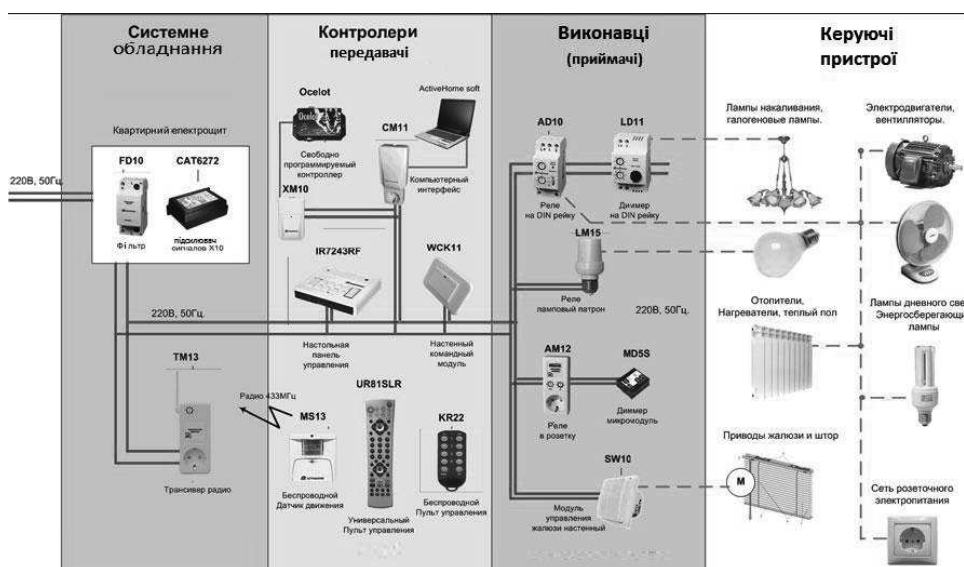
Рисунок 2.3. Схема роботи системи X10
