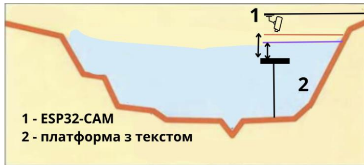
Рисунок 3.3 – Вплив припливів на вимірювання прозорості води
