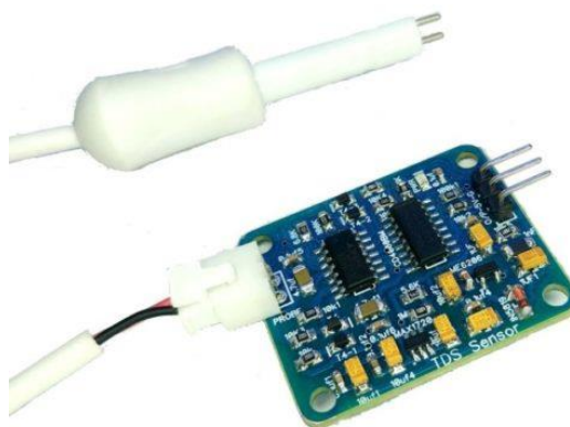
Рисунок 1.5 – Датчик TDS для вимірювання електропровідності [17]
