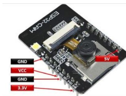
Рисунок 2.7 – Розміщення контактів живлення модуля ESP32-CAM
