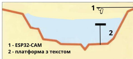
Рисунок 3.2 – Схема розташування компонентів системи контролю води
