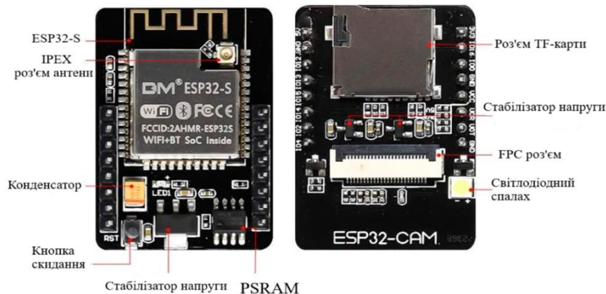
Рисунок 2.2 – Розташування компонентів на платі ESP32-CAM
