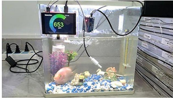
Рисунок 1.9 – Фотографія готової системи моніторингу якості води [18]
