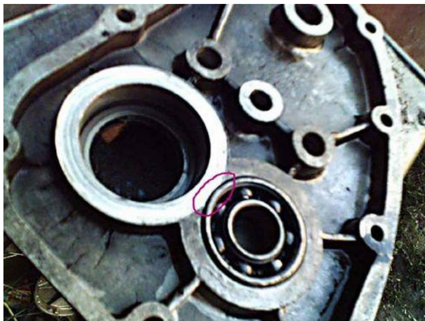
Рисунок 3.9 – Аномальна зона посадочного місця підшипника
