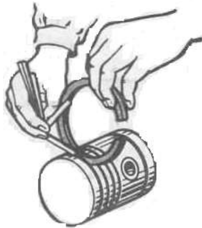
Рисунок 3.3 – Перевірка зазору в спряженні поршневе кільце – канавка поршня
