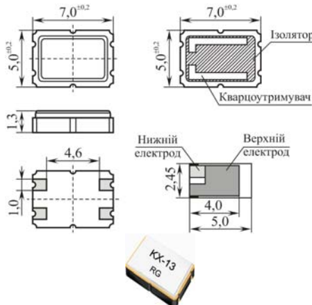
Рис. 4. КР із корпусом типу SMD 7050
