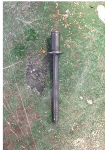
Рисунок 4.1 - Типи використовуваних при випробуваннях заклепок: а) самопробівніє заклепки, б) витяжні заклепки
