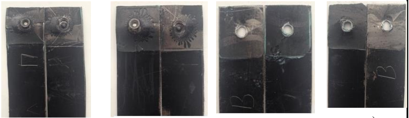
Рисунок 4.5 - Фото поверхні руйнування клеєклепаних з'єднань після випробувань на зрушення: а і б - зразки з самопробівної заклепкою, в і г - з витяжною заклепкою
