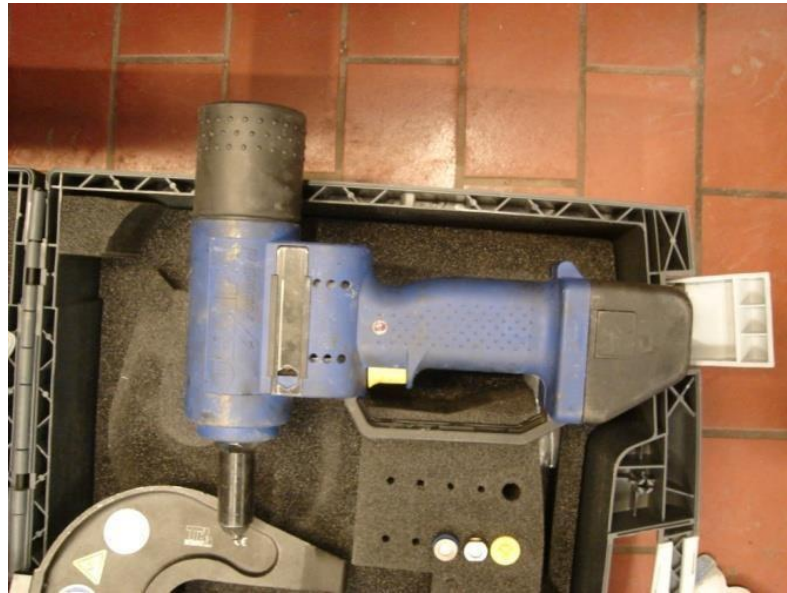
Рисунок 5.5 - Фото ручного акумуляторного заклепочника
