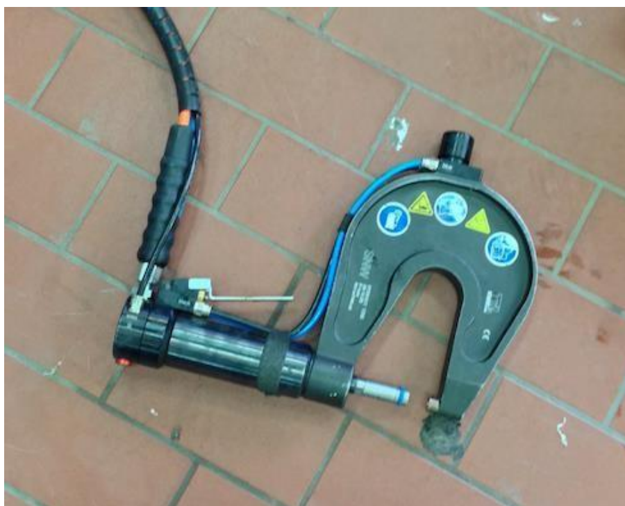
Рисунок 4.2 - Фото ручного заклепочника для установки пресових (самопробівних) заклепок
