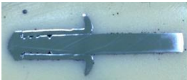
Рисунок 4.3 - Фото шлифов витяжної (а) і самопробівної (б) заклепок
