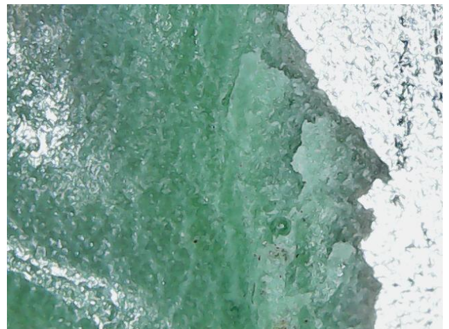
Рисунок 3.8 - Фото різних ділянок поверхні клеєклепаного з'єднання на клеях-розплавах марок Justant-РАК (а, б), Летек (в, г) і МС-1 (д, е)
