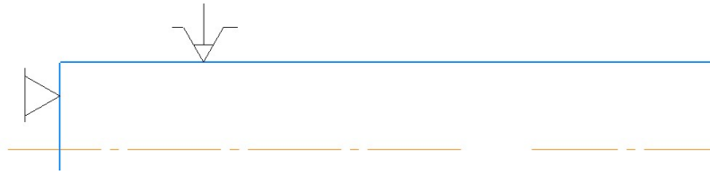
Рис. 2.4 – Схема базування на чорновій операції
