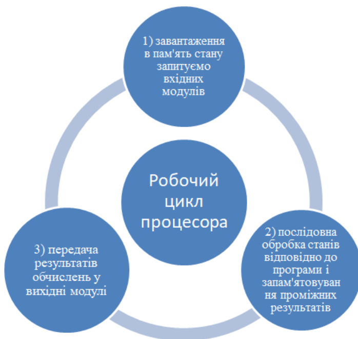
Рисунок 1.13 – Робочий цикл процесора
