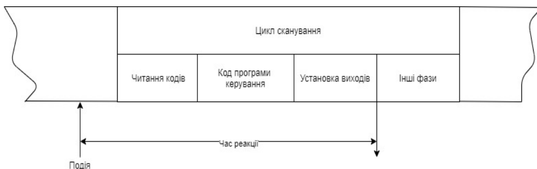
Рисунок 1.18 – Робочий цикл ПЛК
