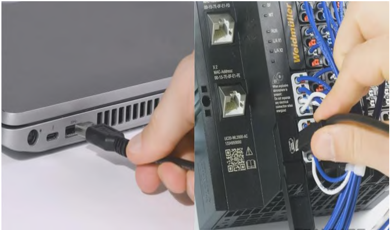
Рисунок 3.1 – З'єднання контролера з комп'ютером
