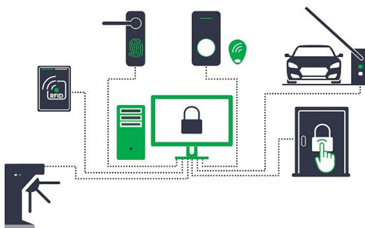
Рисунок 3 – Принципова схема елементів системи контролю доступу RFID для промислового використання [42]
