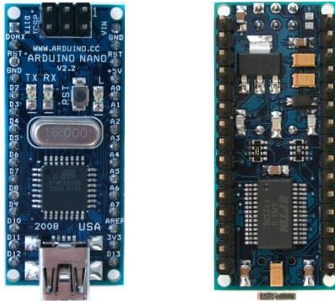
Рисунок 2.5 – Вигляд зверху та знизу плати Arduino Nano
