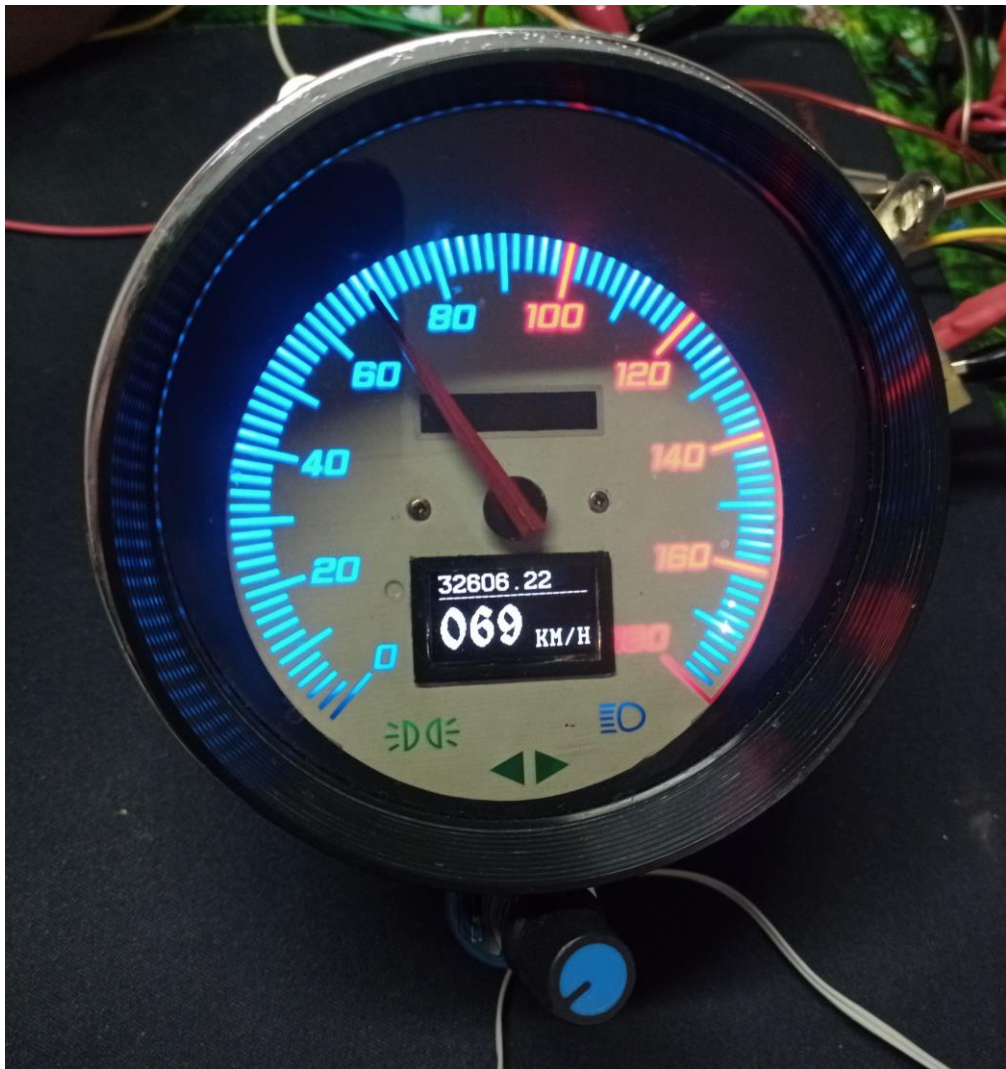
Рисунок 3.4 – Робота самого пристрою з індикацією загального пробігу
