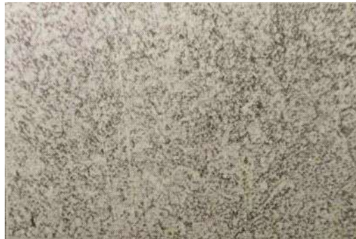
Рисунок 3.7 – Структура сталі ШХ15 –Ш після відпуску
