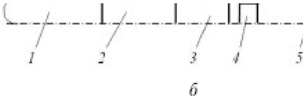
Рисунок 1.12– Схема трizonного черв'яка з конструкційними елементами 1-зона подачі; 2-зона плавлення; 3- зона з конструкційним елементом;4- зона гомогенізації з конструкційними елементами
