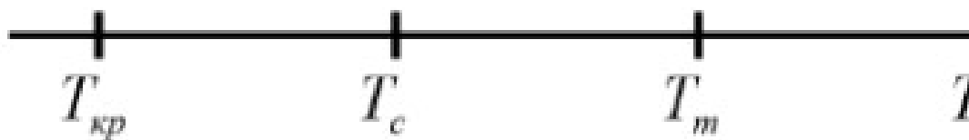
Рисунок 2.1 – Схема температурних фізичних переходів полімерів T_{кр} – температура крихкості; T_c – температура склування; T_m – температура текучості(плавлення); T_d – температура деструкції; T_{кр} - T_c – склоподібний стан; T_c - T_m – еластичний стан; T_m - T_d – в'язкотекучий стан.
