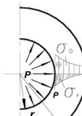
Рисунок 3.2 Розподіл тангенціальних і радіальних напружень по товщині стінки корпусу
