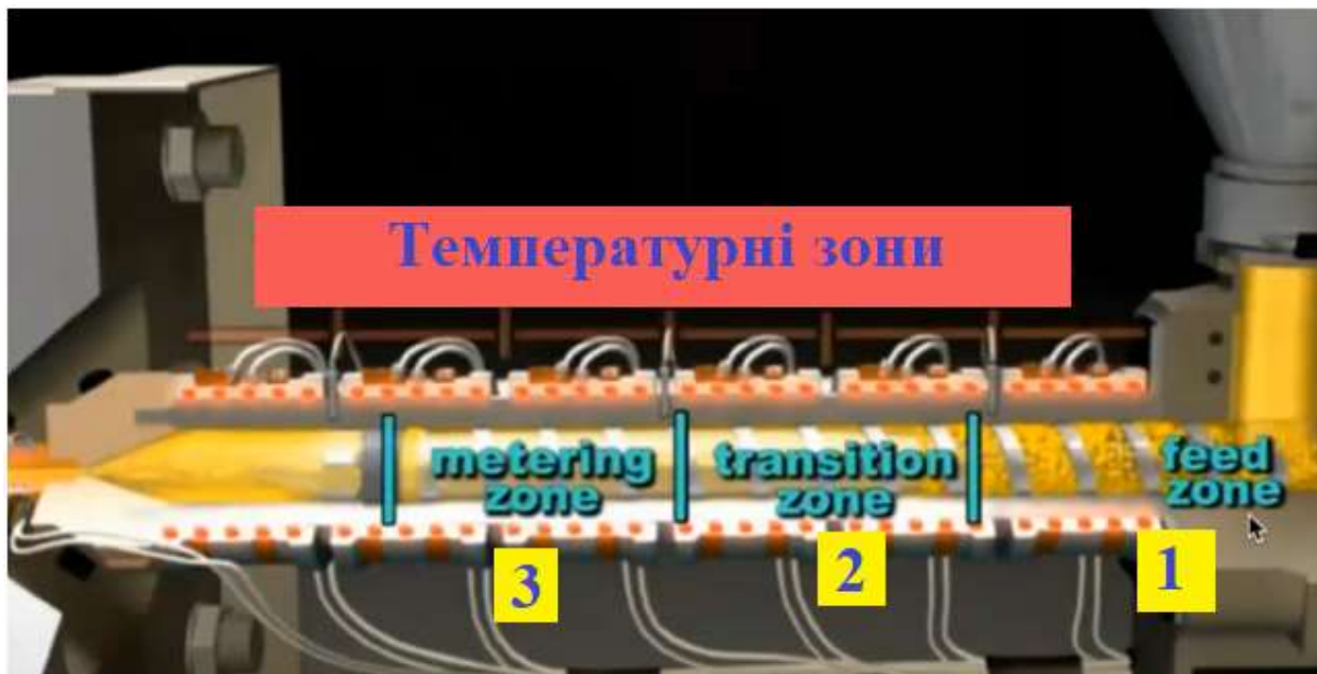
Рисунок 2.4 – Принципова модель просування полімеру в робочих зонах екструзійної машини [2]
