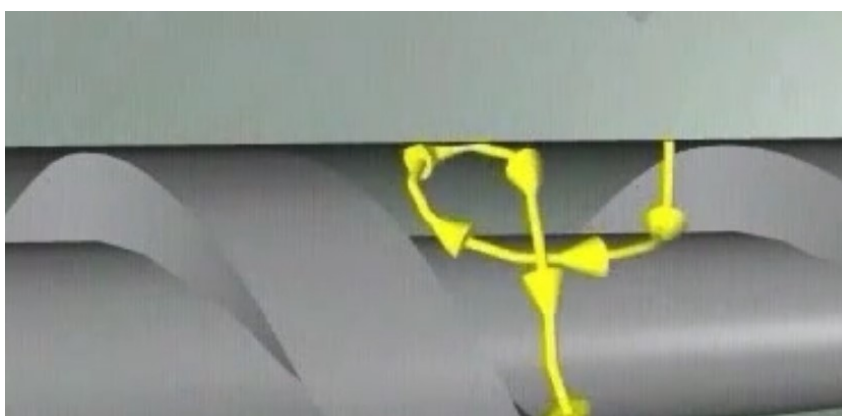
Рисунок 2.6– Траєкторія циркуляційного руху розплаву
