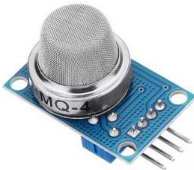
Рисунок 2.8 – Зовнішній вигляд датчику газу MQ-
