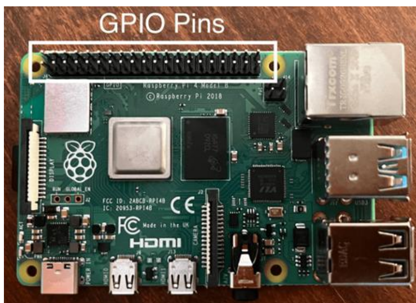
Рисунок 2.2 – Контакти GPIO на платі Raspberry Pi 4B
