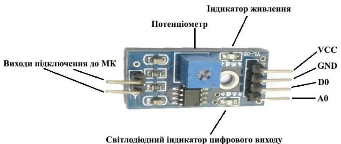
Рисунок 2.6 – Розташування виходів та елементів на датчику дощу FC-37
