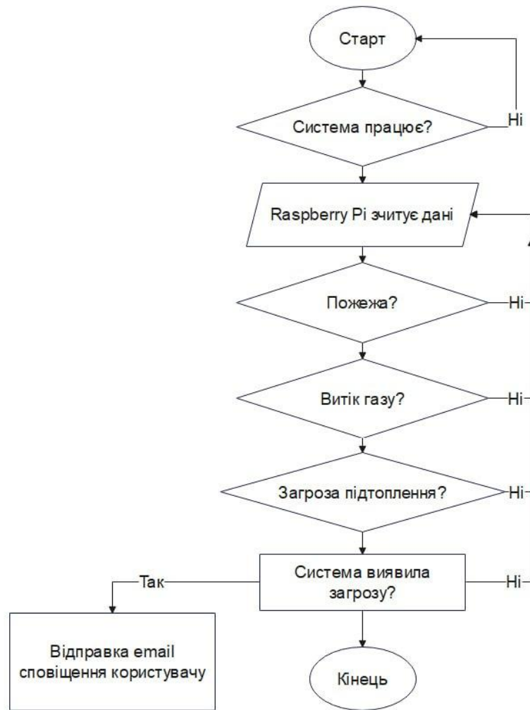
Рисунок 3.1 – Блок-схема алгоритму роботи програмно-технічного засібу керування електронними пристроями з використанням власного веб-сервера
