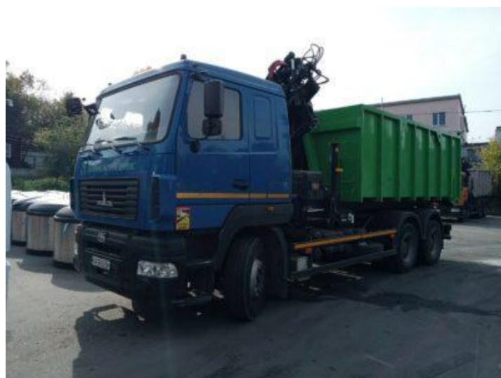
Рисунок 1.4 – Автомобілі МАЗ із системою гакового навантаження типу «мультиліфт» [31]
