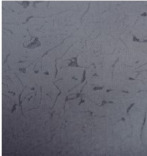
Рисунок 4.8 Мікроструктура шару: зміцнення шляхом взаємодії з оксидом хрому, x400
