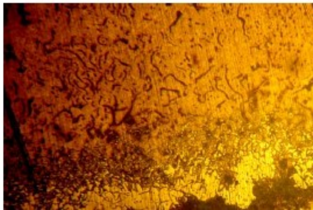
Рисунок 4.9 Мікроструктура шару: зміцнення шляхом взаємодії з оксидом титану, x100
