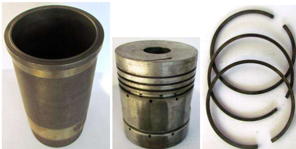
Рисунок 2.13 – Деталі установки одноциліндрового ЦПГ: а – гільза циліндра. б – Поршень. в – поршневе кільце
