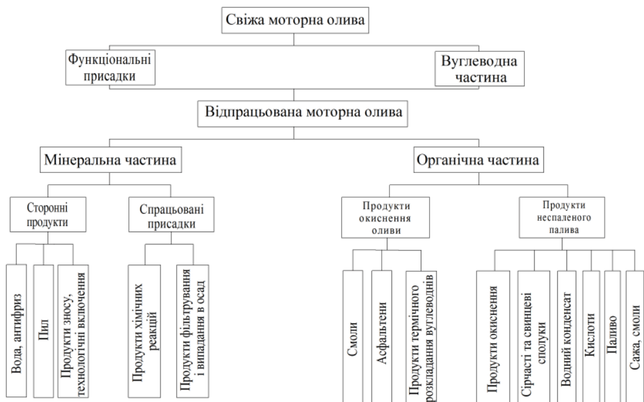
Рисунок 1.2 – Схематична діаграма змін складу моторного масла з часом використання
