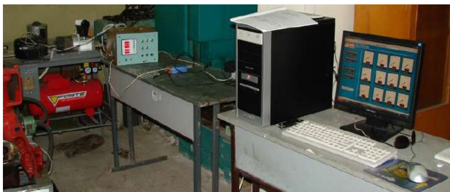
Рисунок 2.6 – Загальний вигляд тестової установки для дослідження роботи головних муфт вузлів компресора Форте ФЛ-24.
