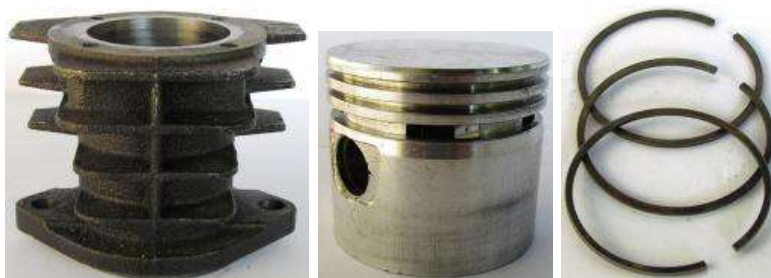
Рисунок 2.10 - Деталі компресора Forte FL-24: а - Гільза циліндра. б – Поршень. в - поршневе кільце
