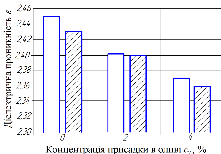
Рисунок 4.8 – Середнє значення діелектричної проникності Масло моторне М10-ДМ
