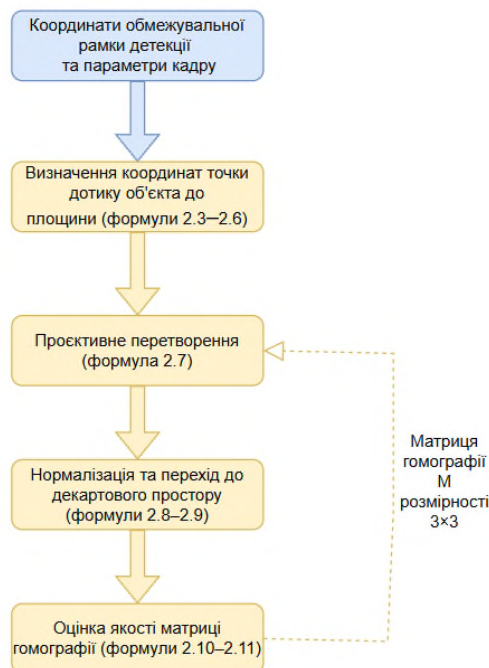
Рисунок 2.6 – Схема обчислення просторової трансформації координат
