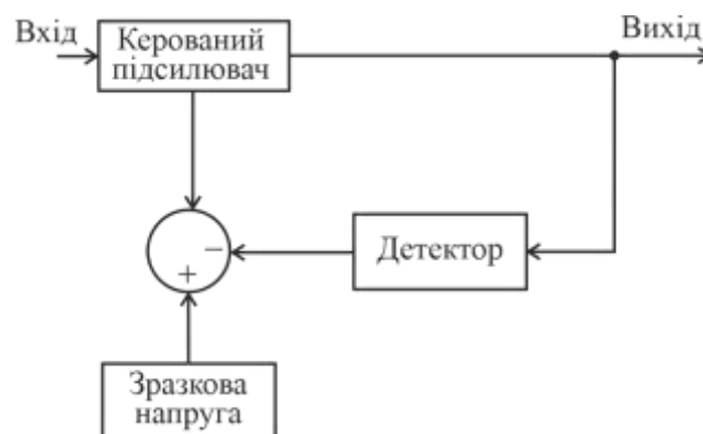
Рисунок 3.1. Схема АРП з використанням підсилювача зі змінним коефіцієнтом пісилення
