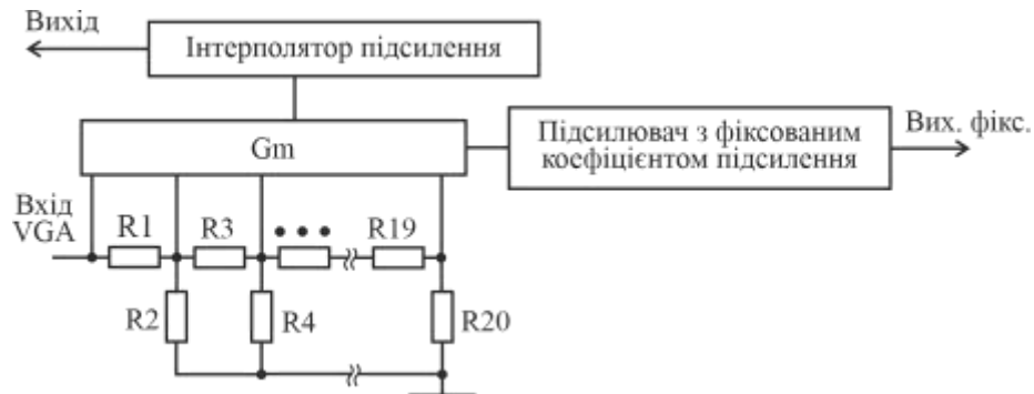
Рисунок 3.3 Багатоланкова мережа AD8336
