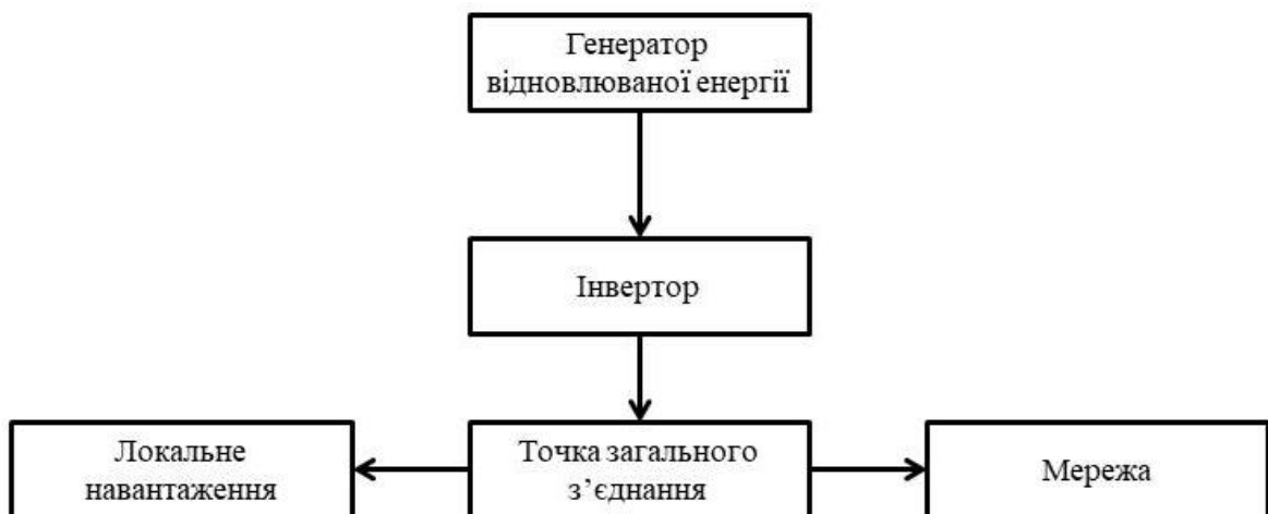
Рисунок 3.1 – Під'єднання генератори відновлюваної енергії до мережі
